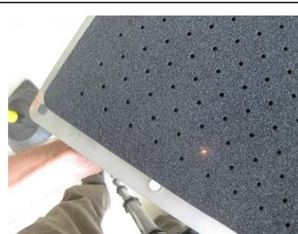
**(10)** Bündigkeit mittels Lichtquellen prüfen/
