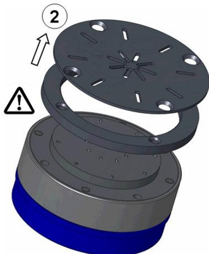
2. Schlitzblech und Distanzring von Grundplatte abnehmen. **Verletzungsgefahr durch überstehende Nadeln!**
