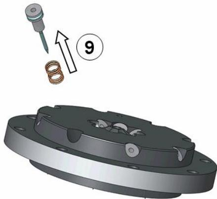
9. Alle alten Nadelkolben und Feder aus Grundplatte entnehmen.
