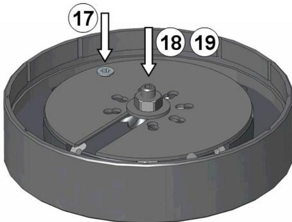
17. Verschlussblech auf Endposition drehen und mit Senkschraube sichern.
