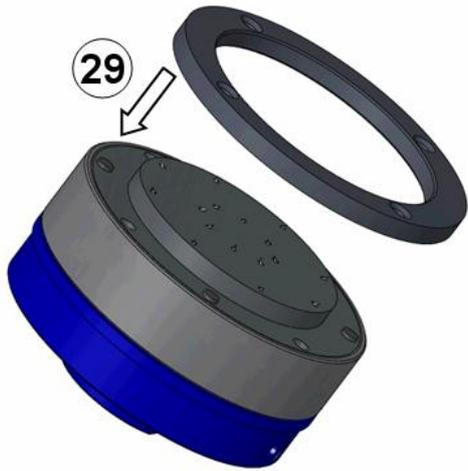
29. Distanzring auf Grundplatte aufsetzen und Bohrungen ausrichten.
