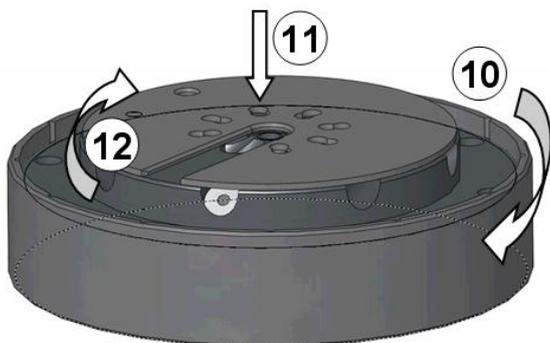
10. Gewinde des Einstellrings gut einfetten und wie dargestellt auf Grundplatte schrauben. Einstellring so einstellen, dass neue Nadeln nicht in Unterlage stechen.
