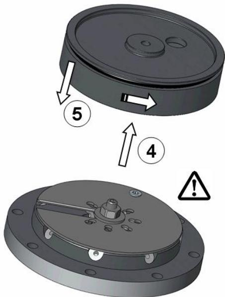
4. Abdeckhaube von Hand von Grundplatte abschrauben (gegen den Uhrzeigersinn). **Verletzungsgefahr durch überstehende Nadeln!**
