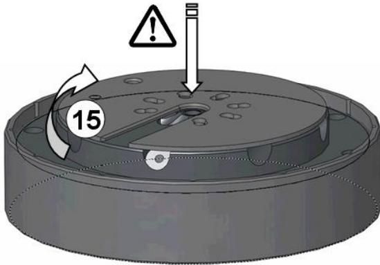
15. Verschlussblech etwas nach rechts drehen, damit nächste Kolbenbohrung am mittleren Kolbenring frei wird. Das Verschlussblech muss während der Montage aller 16 Kolben ständig niedergedrückt werden. **Verletzungsgefahr durch herauspringende Kolben!**
