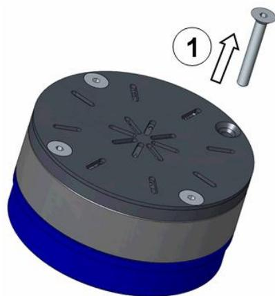
1. 4x Befestigungsschraube auf der Unterseite des Greifers heraus-schrauben.
