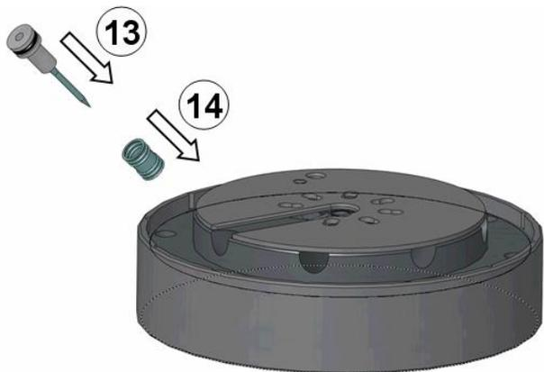
13. Erste Feder in Kolbenbohrung einsetzen.
