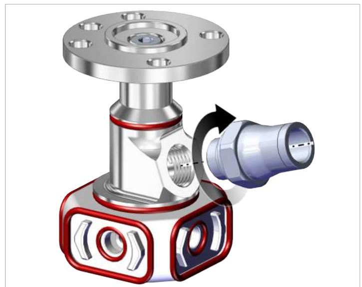
7. Die ausgewählten Distanzstücke lagerichtig auf dem Verteiler (falls erforderlich) montieren und festdrücken.
