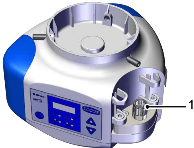
Der elektrische Anschluss der ECBPi an die übergeordnete Maschine bzw. Steuerung (die Spannungsversorgung und die Übertragung der Ein- und Ausgangssignale) erfolgt mit dem beiliegenden Anschlusskabel mit 8-poligen M12-Stecker über die Schnittstelle an Pos. (1).
