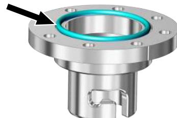
3. Das Flansch-Modul (2) lagerichtig an der ECBPi befestigen ②. Dabei sind die Markierungen am Flansch und am Gehäuse der ECBPi ① zu beachten.
