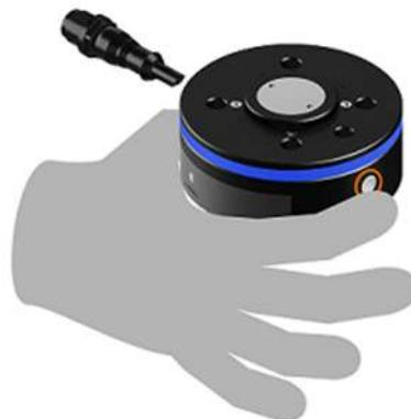
3. Der Roboter wechselt automatisch in den Freedrive-Modus.
