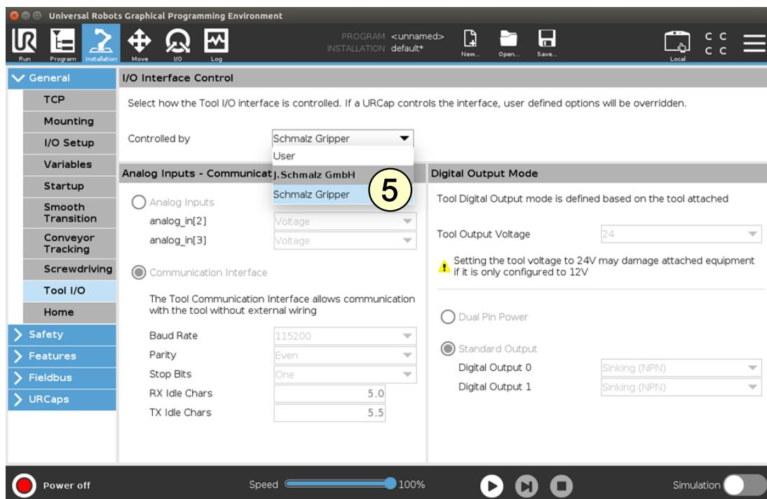
**(5) UR CB-Serie:** Unter "Installation > I/O im Dropdown-Menü" die Gerätekonfiguration "Schmalz-Gripper" auswählen.
