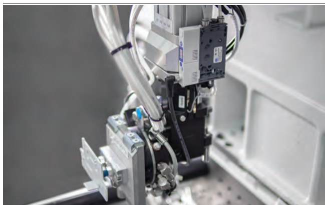
Компактный эжектор SCPMc для обработки пластиковой детали
