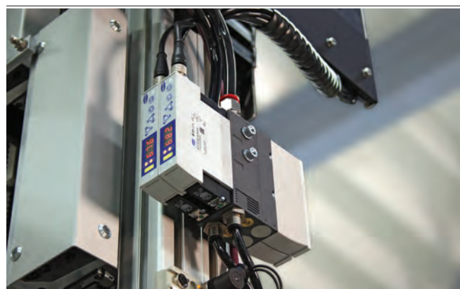
Централизованное генерирование вакуума посредством компактных эжекторов SMPi
