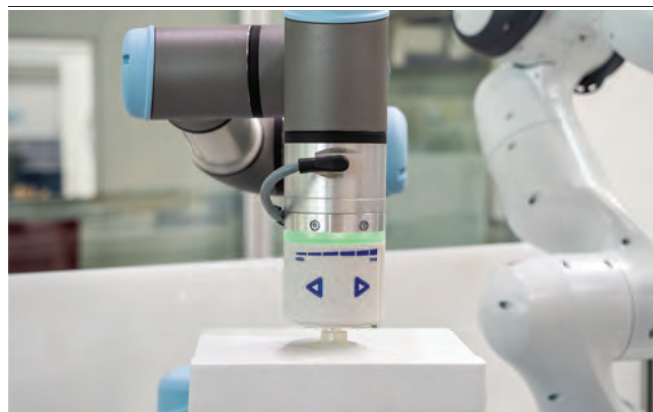
Плоская вакуумная присоска SUF для коробок
