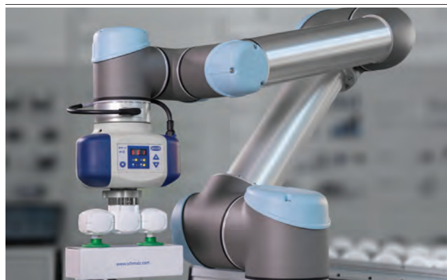
Generatore di vuoto elettrico ECBPi per la movimentazione di scatole di cartone
