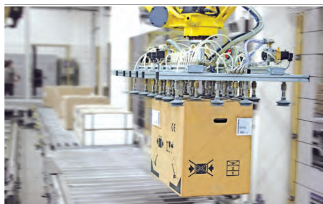
Ventose a soffiutto FSGA per la movimentazione di cartoni
