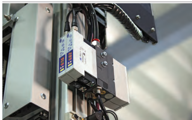
Generazione di vuoto centrale mediante gli eiettori compatti SMPi
