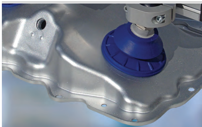
Ventose a soffietto SAB per la movimentazione di parti di carrozzeria di automobili
