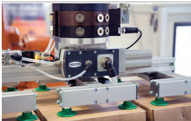
Generazione di vuoto centrale mediante l'eiettori base SBPL
