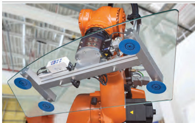
Generazione di vuoto centrale mediante gli eiettori compatti X-Pump SXPi / SXMPi
