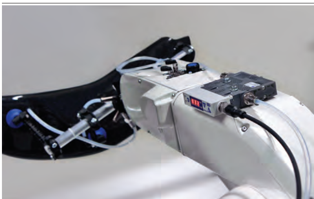
Produzione di vuoto centrale mediante l'eiettore compatto SCPSi
