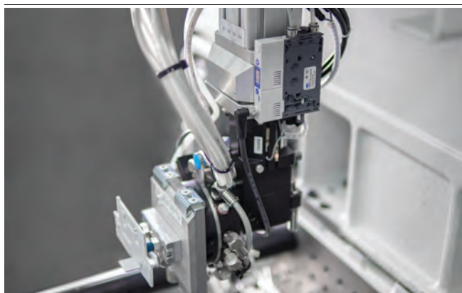
Espulsore compatto SCPMc che manipola un pezzo di plastica
