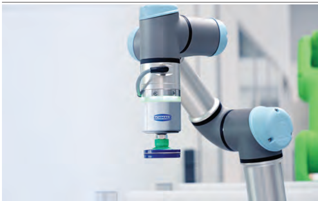
Generatore di vuoto elettrico ECBPMi per la movimentazione di lattine
