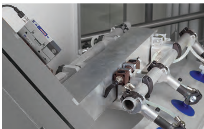
Espulsore compatto SCPI FS RP che manipola un pezzo di carrozzeria
