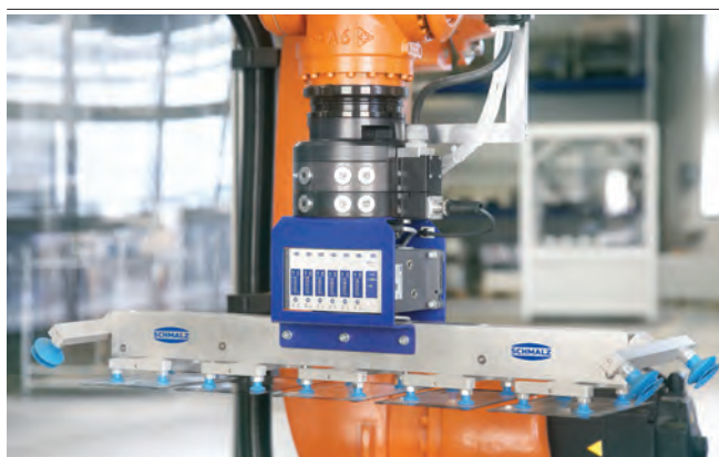
Terminale compatto SCTSi per la movimentazione delle lastre di vetro per i display
