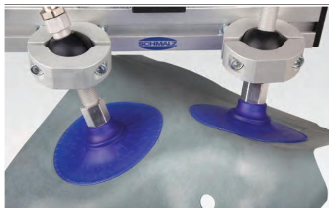
Ventose con supporti universali HTR-UNI per la movimentazione di lamiere
