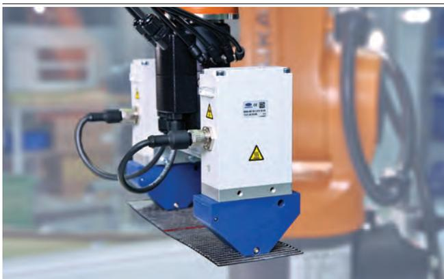
Préhenseurs à aiguilles électriques SNGi-AE lors de la manipulation de textiles composites
