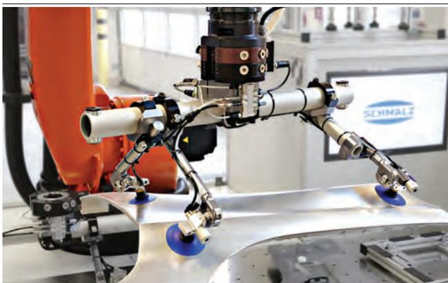
Ventouses cloches SAX pour une manipulation des pièces des tôles
