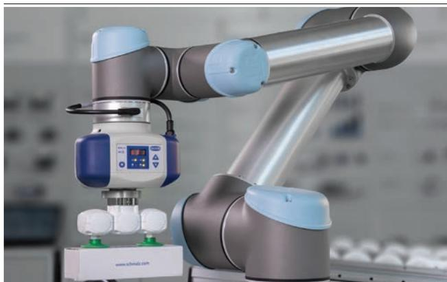
Elektrischer Vakuum-Erzeuger ECBPi bei der Handhabung von Kartons
