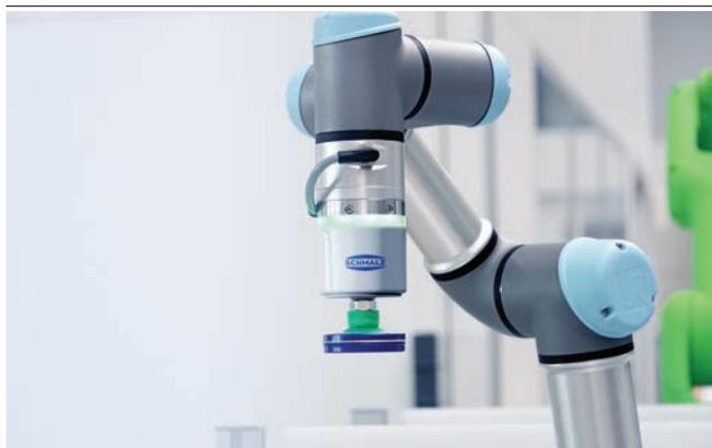
Elektrischer Vakuum-Erzeuger ECBPMi bei der Handhabung von Dosen
