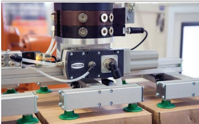
Zentrale Vakuum-Erzeugung durch Grundejektoren SBPL
