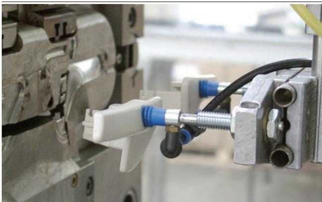
Balgsauggreifer FSG bei der Handhabung von heißen Kunststoffteilen
