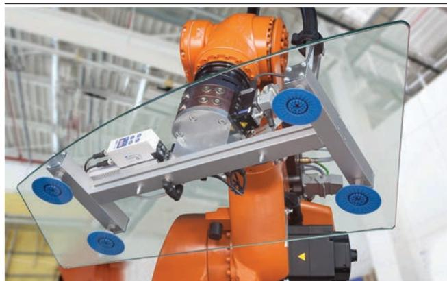
Zentrale Vakuum-Erzeugung durch Kompaktejektoren X-Pump SXPi / SXMPi
