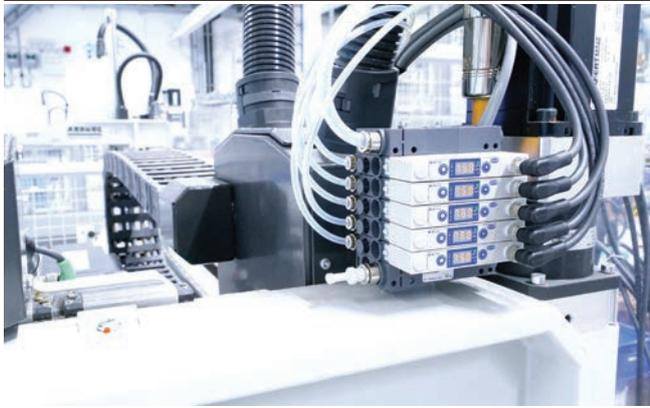
Kompaktterminal SCTMi zur Vakuum-Erzeugung bei der Entnahme von Spritzgussteilen
