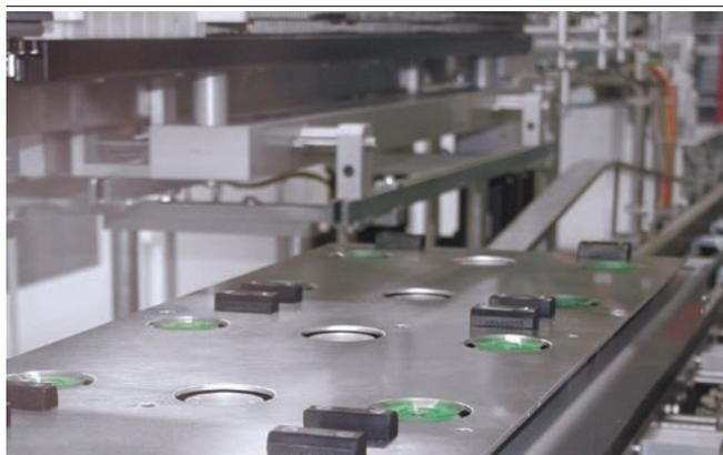
Flachsauggreifer SPF beim Einsatz in Kartonieraufrichtern
