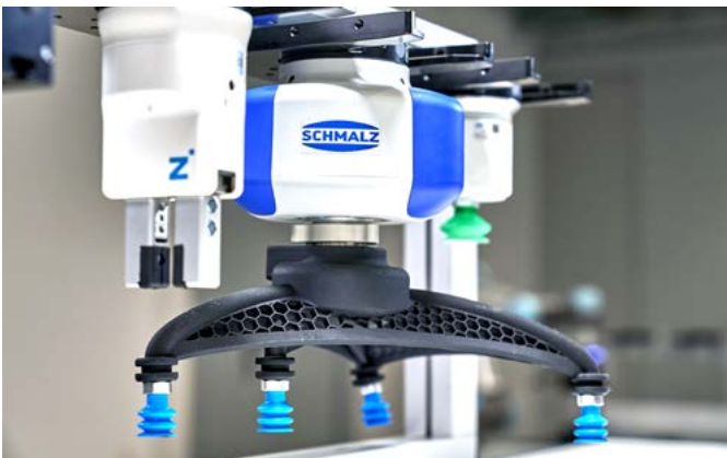
Verschiedene Greifer können manuell oder automatisiert in einem Greiferbahnhof eingewechselt werden
