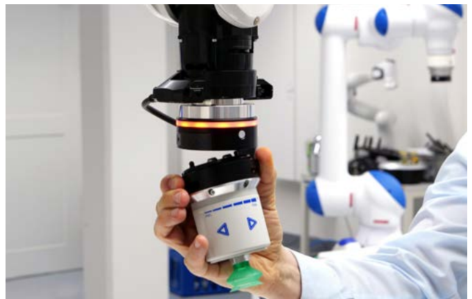
Manueller Wechsel mit Ein-Hand-Funktion innerhalb von Sekunden
