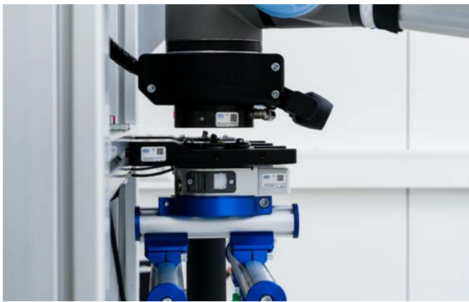
Automatisierter Wechsel (ohne externe Ansteuerung)
