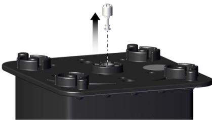
Ziehen Sie die Kunststoffkappe des Tastventils mit Hilfe einer Zange aus der Aluminiumhülse.
