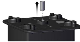
Bohren Sie nun die Aluminium- Hülse mit einem Bohrer (D7,6) auf.
