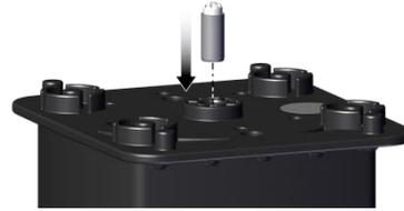
Pressen Sie das neue Tastventil in die dafür vorgesehene Bohrung. Alternativ können Sie das Tastventil auch mit leichten Schlägen einklopfen.
