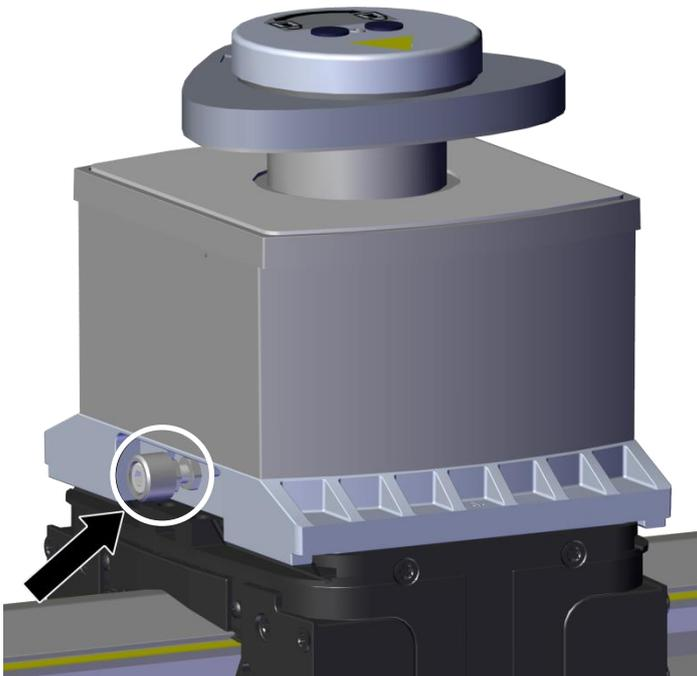
Hiermit wird der Abstand zwischen Schlitten und Anschlagzylinder eingestellt. / This is to adjust the distance between slide and stop cylinder.
