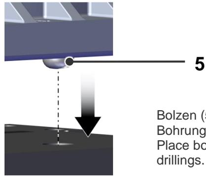
Bolzen (5) in die Bohrungen einsetzen. / Place bolt (5) into the drillings.
