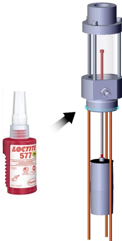
Schritt 11: Neuen Schwimmer mit einem Gabelschlüssel (Größe 50) oder einer Rohrzange eindrehen
