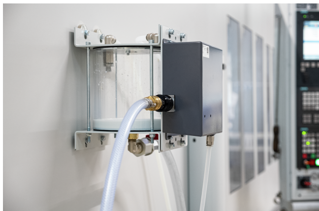
Generatore di vuoto CVU su centro di lavorazione CNC per la lavorazione del metallo
