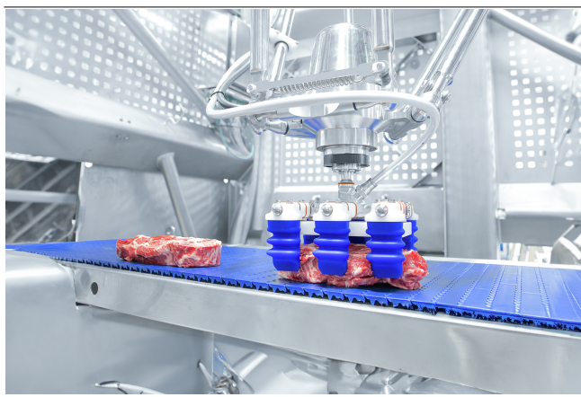
Fingergreifer mGrip bei der Handhabung von Lebensmitteln
