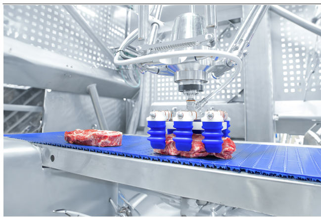
Préhenseur à doigts mGrip pour la manipulation des produits alimentaires
