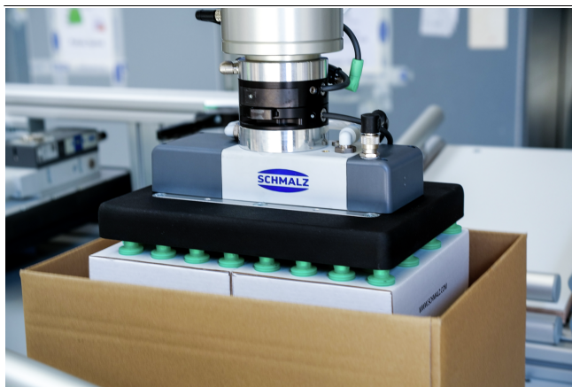
Sistema di presa ad area FQE-V Xc per la pallettizzazione di scatole di cartone
