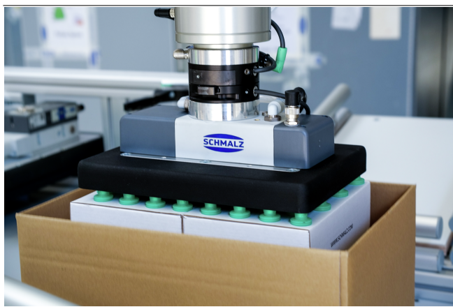
Sistema de planos aspirantes FQE-V Xc para paletizar cajas de cartón
