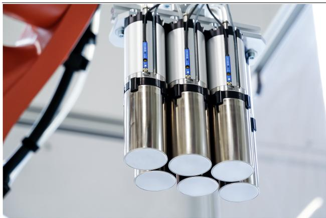
Ventosa magnetica per la manipolazione di celle di batteria tonde
