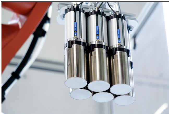
Magnetgreifer bei der Handhabung von Batterie-Rundzellen
