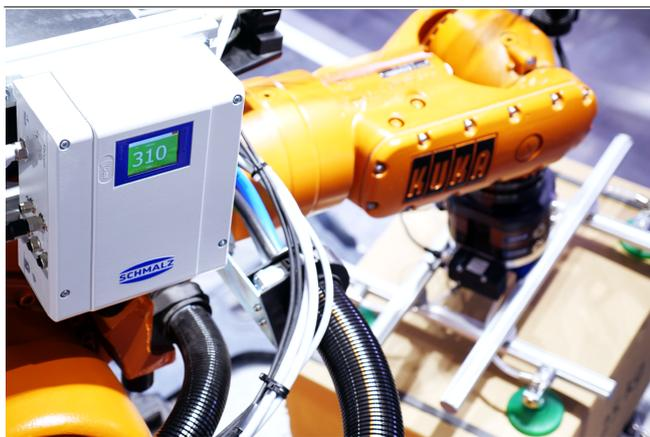
Elektrische Compact-Pump GCPI bei der Handhabung von Kartonagen
