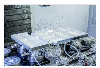
Blocksauger CMB-HD mit hohen Spannkräften bei der Bearbeitung von Aluminium auf CNC-Bearbeitungszentrum
