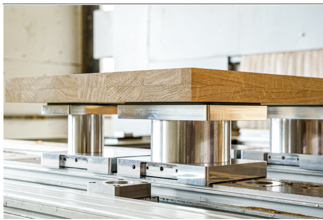
Blocksauger VCBL-K2-HD beim Aufspannen von Massivholz
