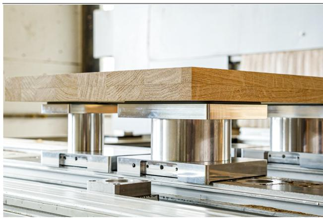
Blocco di aspirazione VCBL-K2-HD per il bloccaggio di legno massiccio
