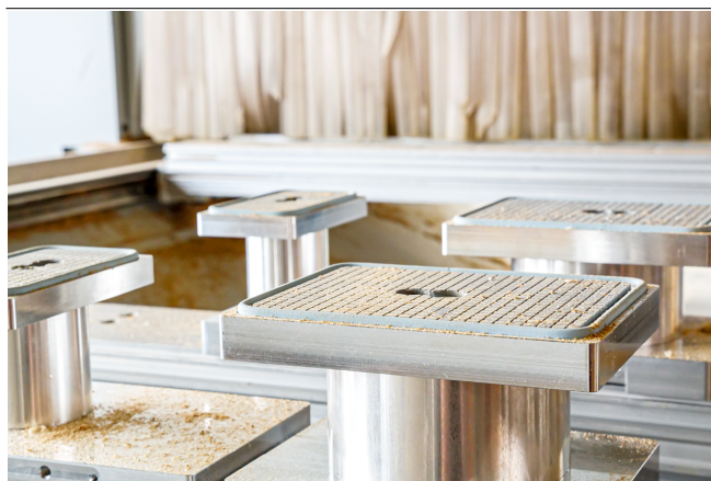
Ventosa de bloque VCBL-K1-HD para fijar madera maciza
