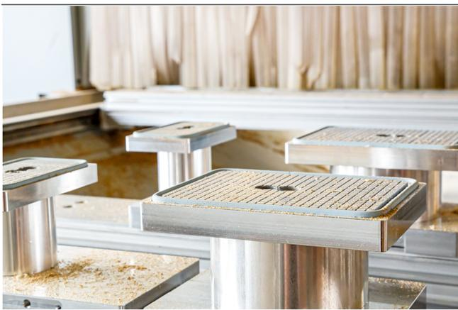
Blocco di aspirazione VCBL-K1-HD durante il bloccaggio del legno massiccio
