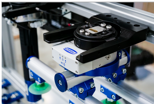
Generatore di vuoto pneumatico RECBi MATCH per la movimentazione di cartoni
