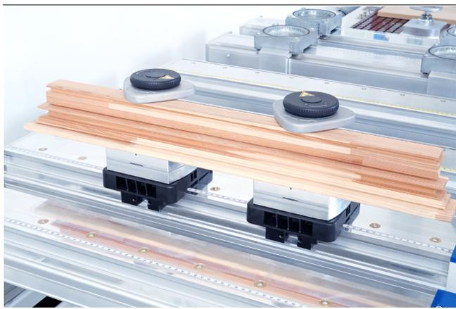
Bloc de serrage VCMC-S6-QUICK serrage d'éléments de cadre
