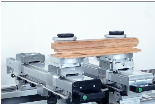
Bloccaggio meccanico VCMC-B-QUICK serraggio di parti del telaio
