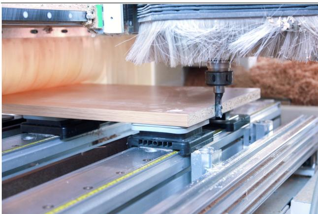
Blocs de bridage par le vide VCBL-S utilisé sur des consoles SCM
