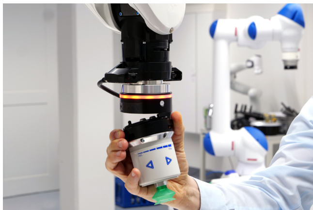
Schnellwechselmodul RMQC beim manuellen Greiferwechsel
