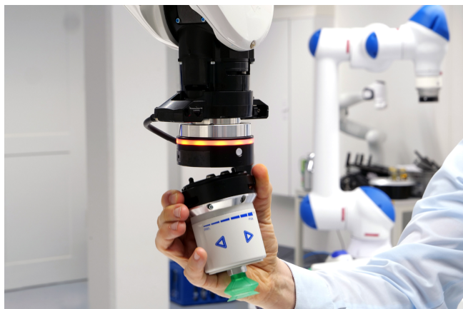
Modulo di cambio rapido RMQC durante il cambio manuale della pinza di presa
