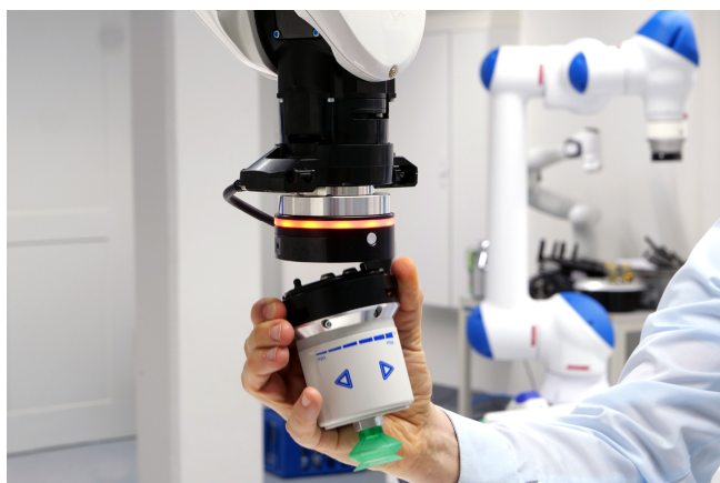
Module de changement rapide RMQC lors du changement manuel de préhenseur
