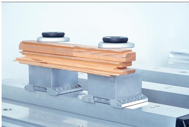
Mechanischer Spanner VCMC-K2-QUICK beim Aufspannen von Rahmenteilen
