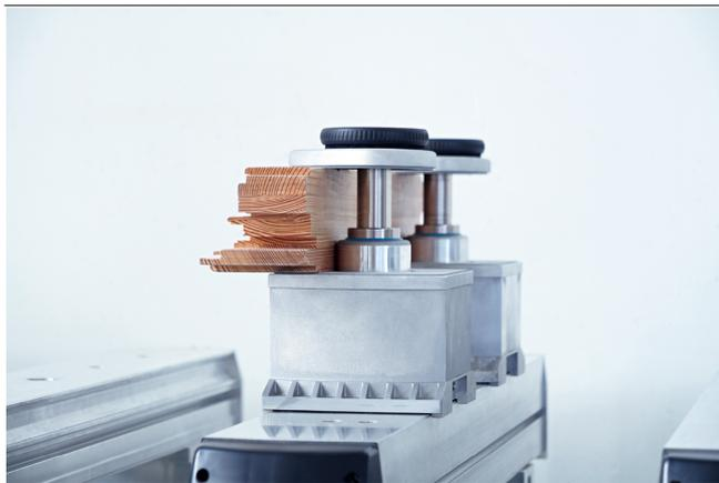
Mechanische Spanner VCMC-K1-QUICK beim Aufspannen von Rahmenteilen
