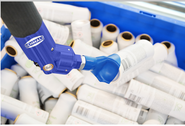
Deodorant sprey kutularının taşınması için Schmalz Bin-Picker SBPG
