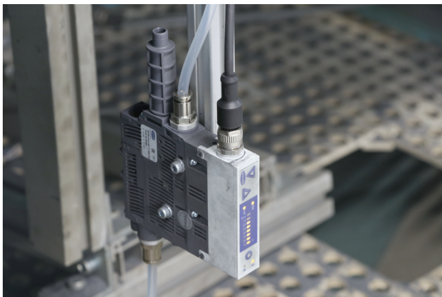
Montagebeispiel Kompaktejektor SCPS-UHV-HD
