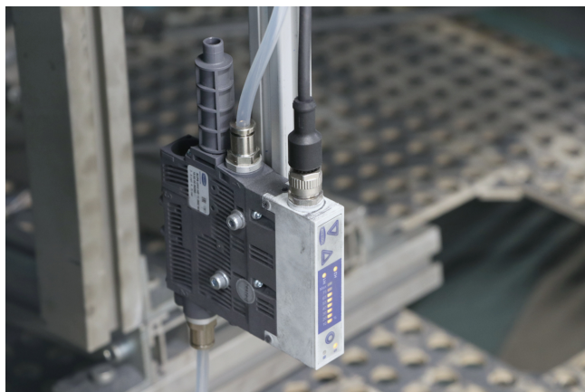
Exemple de montage d'un éjecteur compact SCPS-UHV-HD
