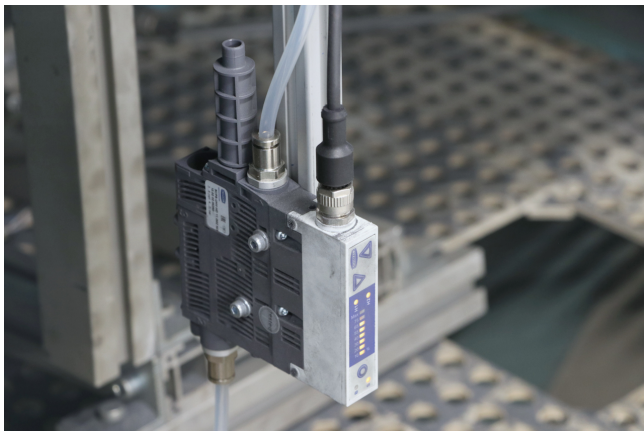
Exemple de montage d'un éjecteur compact SCPS-UHV-HD
