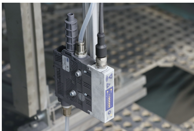
Esempio di montaggio dell'eietttore compatto SCPS-UHV-HD
