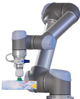
Vakuum-Endeffektor VEE bei der Handhabung von kleinen Verpackungen
