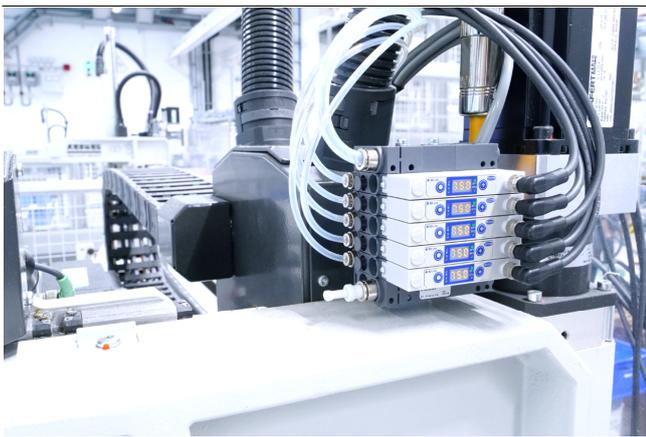
Kompakterminal SCTMi zur Vakuum-Erzeugung bei der Entnahme von Spritzussteilen
