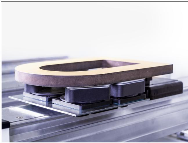
Adapter-Plates ISAP-S con Mono-Base y ventosas fijando piezas de madera curvas
