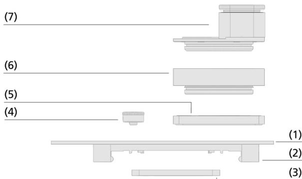
Diseño del sistema Adapter-Plates ISAP-S
