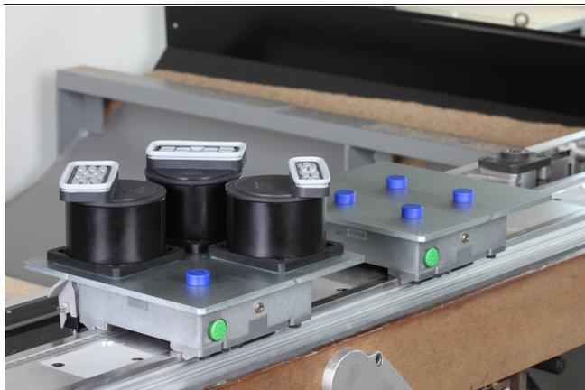
Adapter-Plates ISAP-B con Mono-Base y ventosas fijando piezas de madera
