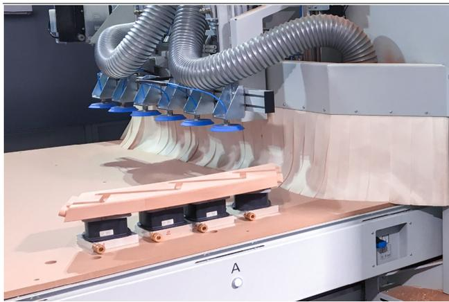
Adapter-Plates AP-G mit Blocksaugern VCBL-B beim Aufspannen eines Holzwerkstücks
