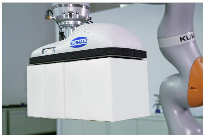
Sistema di presa ad area FMCB per la movimentazione di scatole di cartone
