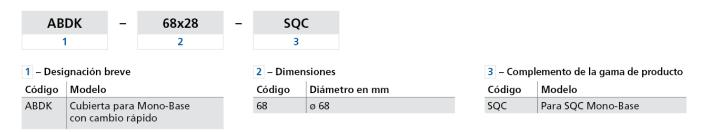
El sistema Quick-Change de Schmalz no se suministra montado. El sistema consiste en tres componentes, que se piden de forma independiente:
