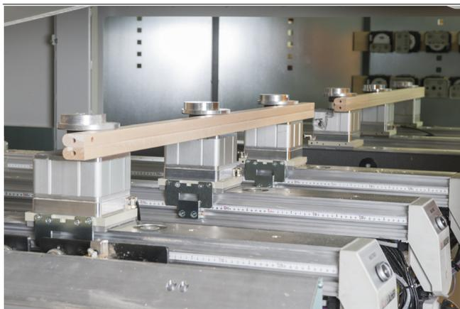
Blocs de bridage VCMC-K1 pour le bridage d'éléments de cadre
