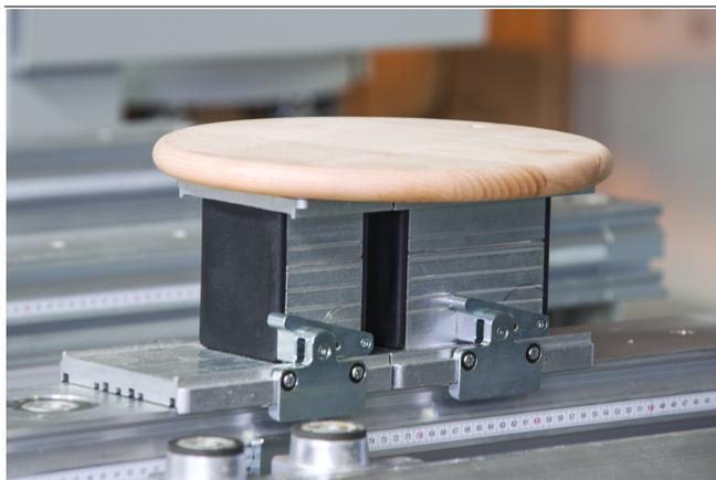
Blocs de bridage par le vide VCBL-A-K1 pour le bridage de pièces en bois massif
