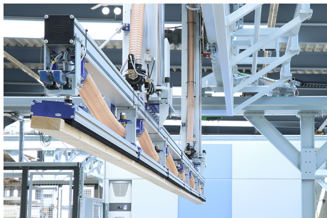
Sistema di presa a vuoto ad area FMP durante la movimentazione di assi di legno strutturate
